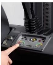
Painel digital: Freio de Estacionamento, pressão do óleo do motor, temperatura do moto, Alerta do Combustível/Baixo, Alerta da Temperatura do Óleo da Transmissão, Alerta da Carga da Bateria, Medidor de Combustível e Horímetro.
