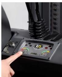
Luz Indicadora de Freio de Estacionamento, Luz Indicadora de Alerta do Combustível/Baixo, Luz Indicadora de Alerta da Temperatura do Óleo da Transmissão, Luz Indicadora de Alerta da Carga da Bateria, Espelhos Retrovisores, Medidor de Combustível, Horímetro e extintor de incêndio
