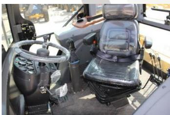
Cabine fechada ROPs/FOPs com ar condicionado sobre chassis traseiro com visão ampla, sistema completo de iluminação, de retrovisores e avisos sonoros. Comandos da caçamba frontal e da retro. Faróis auxiliares dianteiros e traseiros montados na cabine. Assento com suspensão. Tampa protetora do painel lateral. Capô basculante com amortecedor. Comando por Joystick opcional.
